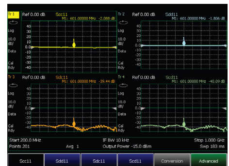
S-параметры смешанного режима позволяют оценить отражения в синфазном и дифференциальном режимах
