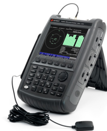
Получение данных геопозиционирования со встроенного GPS-приемника
